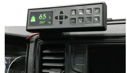
Pantalla del panel de interruptores de Modul-Connect
